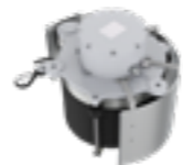
Кабельная катушка внутри стрелы
