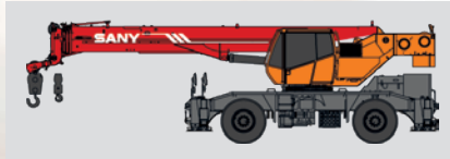
SRC400C Макс. грузоподъемность: 40 т Стрела: 4 секционная, 10–31,5 м Шасси: 4x4x4
