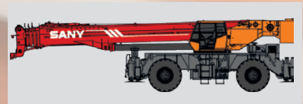
SRC1200C Макс. грузоподъемность: 120 т Стрела: 5 секционная, 13–49 м Шасси: 4x4x4
