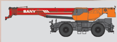
SRC900C Макс. грузоподъемность: 90 т Стрела: 5 секционная, 12,2–47 м Шасси: 4x4x4
