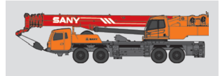
STC800 Макс. грузоподъемность: 80 т Стрела: 5 секционная, 12,2–47 м Шасси: 8x4x8
