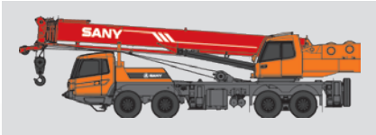
STC250-5 Макс. грузоподъемность: 25 т Стрела: 5 секционная, 10,5–40,5 м Шасси: 6x4x2
