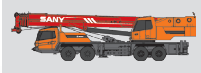
STC500 Макс. грузоподъемность: 50 т Стрела: 5 секционная, 11,3–43,5 м Шасси: 8x4x4
