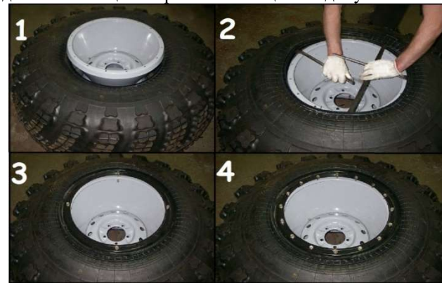
Рис. 10.4 Порядок монтажа шины ТРЭКОЛ
